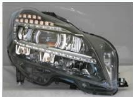
Mercedes-Benz CLS – První sériově vyráběný Full LED světlomet s dynamickým natačením
