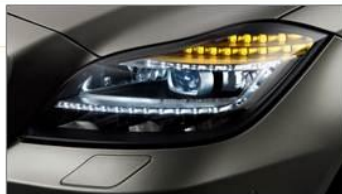
Mercedes-Benz CLS – První sériově vyráběný Full LED světlomet s dynamickým natačením
